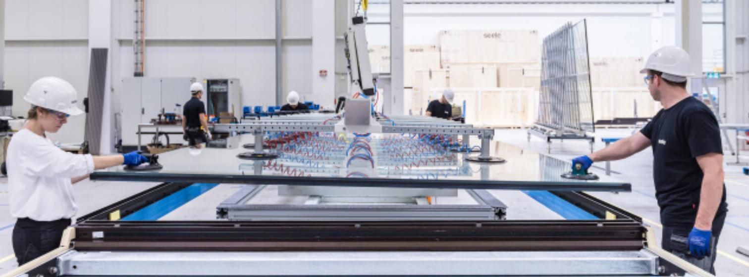
Assemblaggio di elementi SCF di dimensioni pari a circa 7 x 4 m per il Principal Place Commercial di Londra. (Foto: René Müller, seele GmbH)
