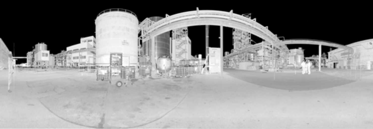
Bestandsaufnahme einer Chemieanlage für die Ölproduktion mit Skalypso (©IBG)
